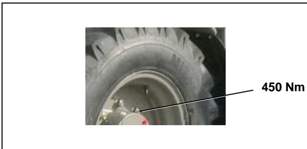
Abbildung 115 Radmuttern nachziehen
