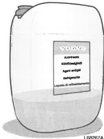
Bei Auslieferung der Maschine ist das Kühlsystem mit Kühlschutzmittel bis zu  $-25\text{ }^{\circ}\text{C}$  gefüllt. Besteht die Gefahr, dass die Maschine noch niedrigeren Temperaturen ausgesetzt wird, muss genügend Kühlschutzmittel begefüllt werden.
